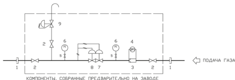
Сх.01 Группа редуцирования давления на одной линии
